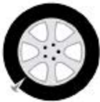
Einfahrtschäden (z. B. Nägel, Schrauben, Scherben etc.)
